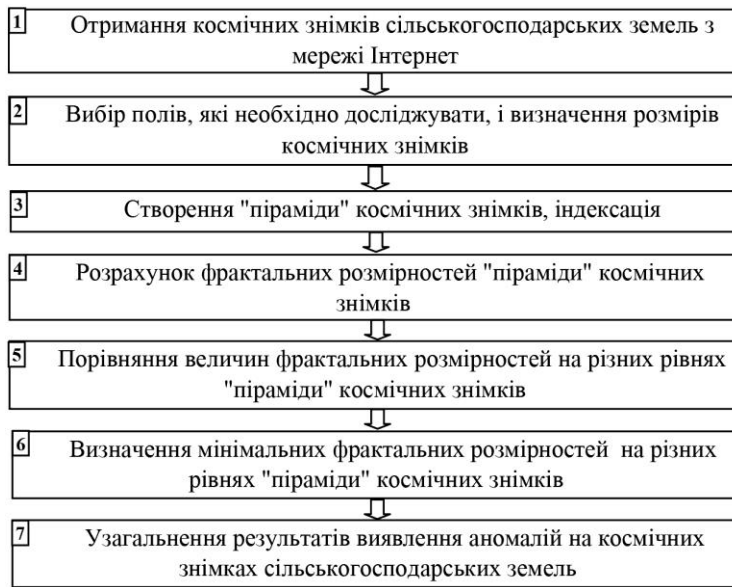
Рис. 5. Структурна схема методу виявлення аномалій на космічних знімках сільськогосподарських земель із використанням "пірамідального" фрактального аналізу
