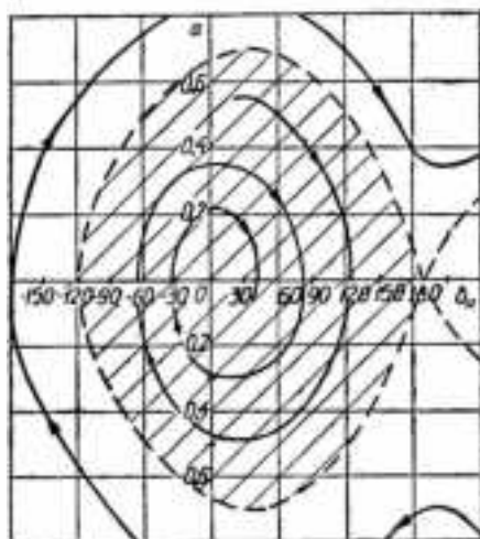
Рис. 2. Фазовая плоскость для неавтономной системы с учетом диссипативных сил
