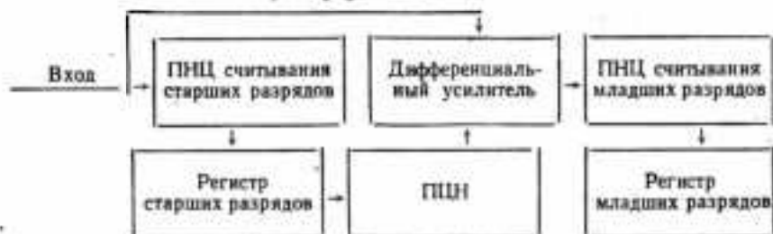
Рис. 5. Структурная схема двухкаскадного ПИЦ, реализующего комбинацию методов считывания и паразрядного кодирования
