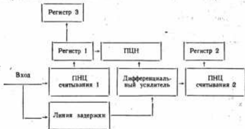
Рис. 6. Структурная схема двухкаскадного «конвейерного» ПИЦ.
