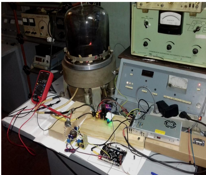
Рис. 12. Система керування нагрівачем в вакуумі
